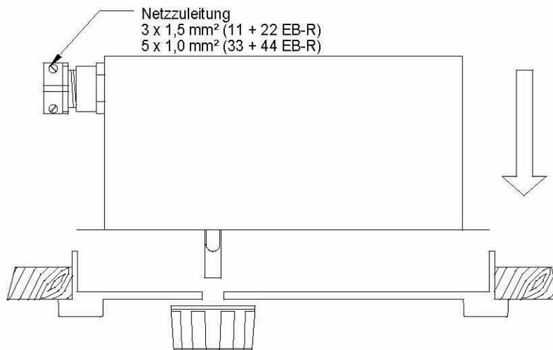
Netzkabel und Metallschlauchverbindung zur Heizplatte in diesen Ansichten nicht gezeichnet
